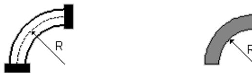
Nel riquadro Raggi di curvatura massima cavi, impostare i raggi delle curve che un cavo subisce all'interno del giunto; la curva può essere definita tra due elementi rettilinei con curva singola a 90°, oppure tra tre elementi con due curve a 45°, o tra quattro elementi con tre curve a 30° (le seguenti casella sono attive solo per gli elementi di giunzione).
