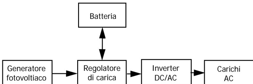
Ai componenti prima descritti si aggiunge un inverter DC/AC; si tratta di un convertitore DC/AC, caratterizzato dal proprio rendimento di conversione, attraverso cui l'energia di origine fotovoltaica e l'energia erogata dalla batteria, in corrente continua, devono passare per poter alimentare il carico in corrente alternata.
