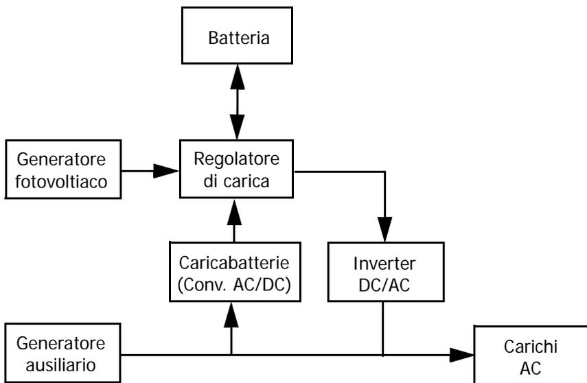
Tipicamente in un impianto a isola ibrido i carichi sono in alternata; ai classici componenti che caratterizzano un impianto a isola (generatore fotovoltaico,
