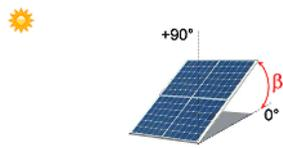
Orientamento (azimut): -15 °   Inclinazione (tilt): 35 °
