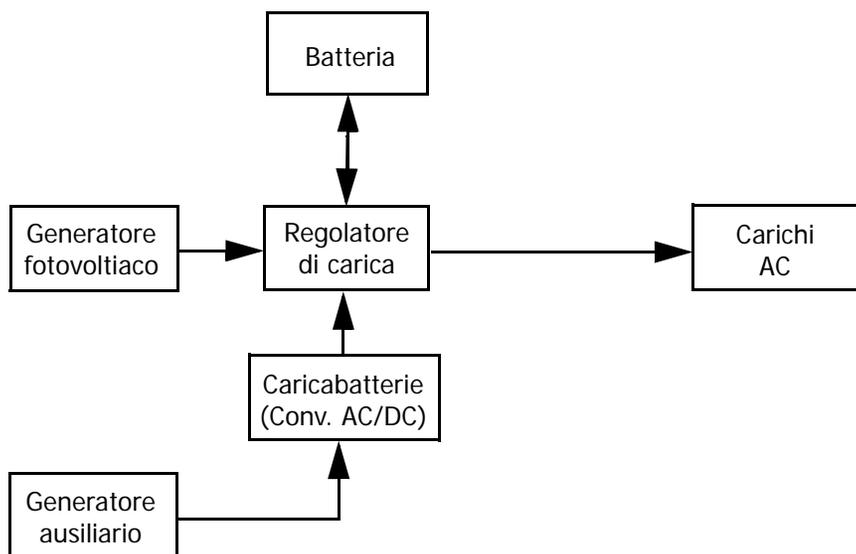
Non è più necessario l'inverter DC/AC in quanto l'energia fotovoltaica prodotta e l'energia erogata dalla batteria possono essere direttamente utilizzate, mentre rimane il convertitore AC/DC attraverso cui deve passare l'energia erogata dal generatore ausiliario per poter alimentare il carico e/o ricaricare la batteria.
