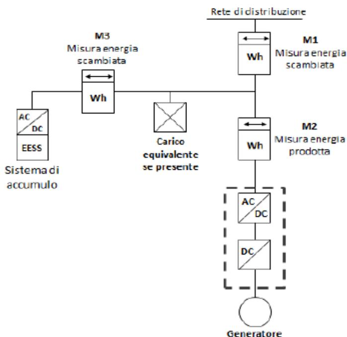
Si riporta infine di seguito uno schema esemplificativo idoneo all'accesso al servizio di valorizzazione e incentivazione dell'energia condivisa relativo a un impianto con potenziamento e accumulo oltre a una tabella con indicazione della tipologia di contatore da installare a seconda dei casi.
