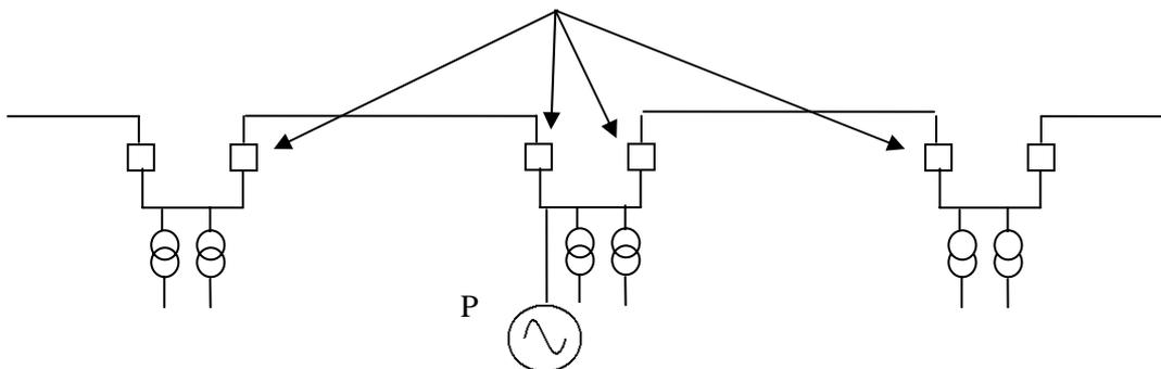
**Figura E-7**- Produttore connesso in antenna
