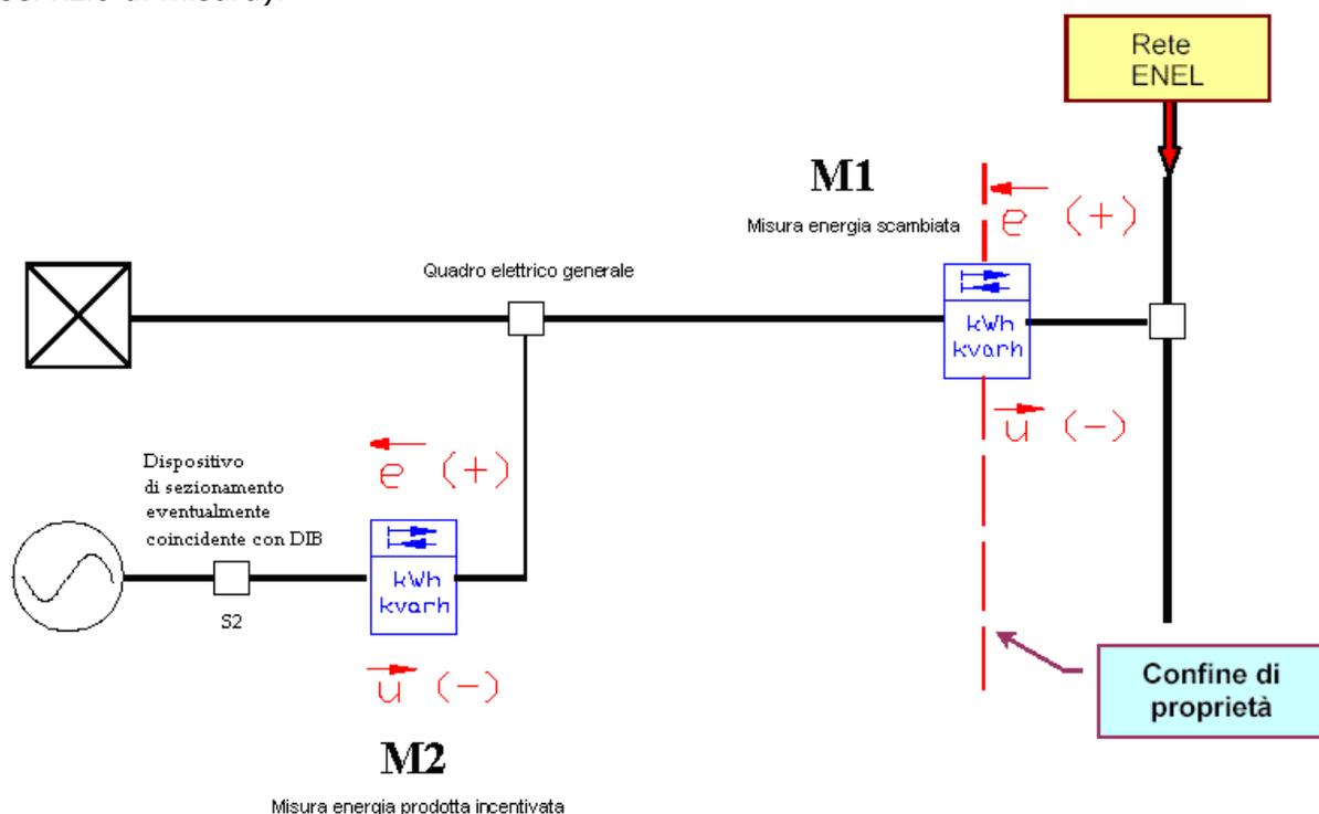
Figura H-1 Schema di collegamento dei sistemi di misura Enel presso un Produttore con servizio di scambio sul posto o che effettua la cessione "parziale" in rete dell'energia prodotta.
