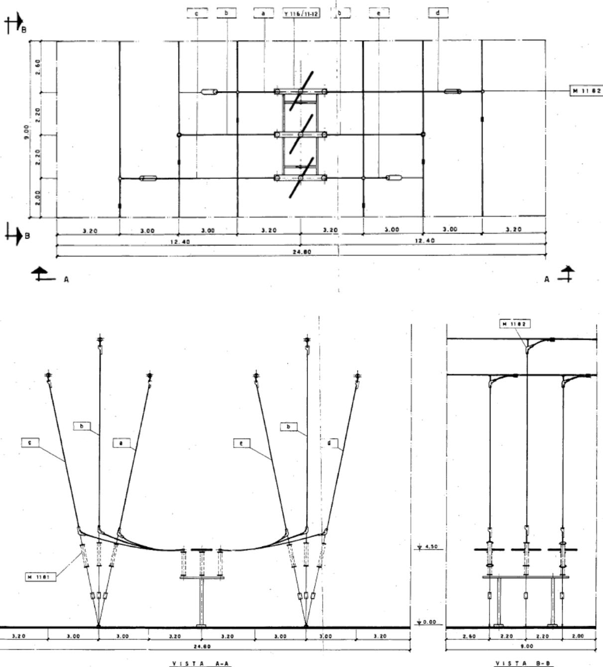
Figura G-7: Esempio di Sezionamento per consegna
