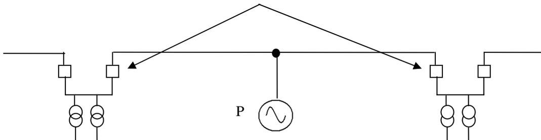
**Figura E-8** -Produttore connesso in derivazione rigida a "T"
