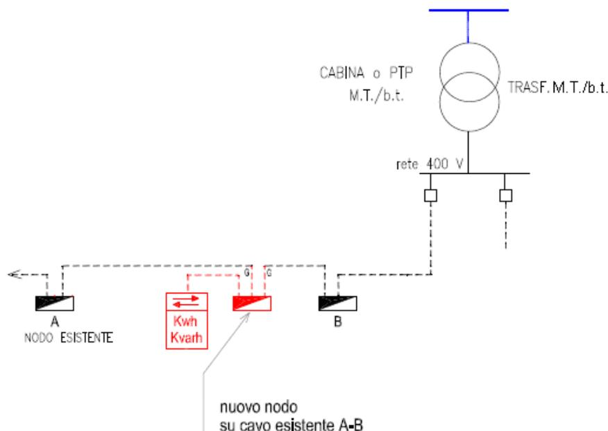
Figura D-2: Soluzione tecnica di connessione in entra-esce da linea esistente con realizzazione di un nuovo nodo (ed eventuale tratto di linea) BT
