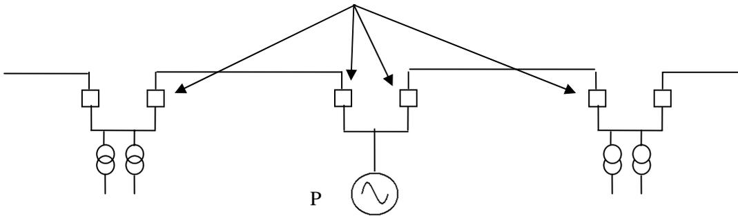
**Figura E-6** - Produttore connesso in entra-esce
