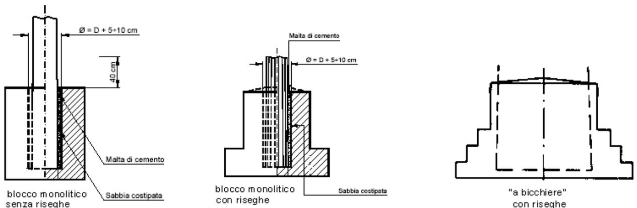
Figura G-13: Tipologie di fondazioni unificate Enel
