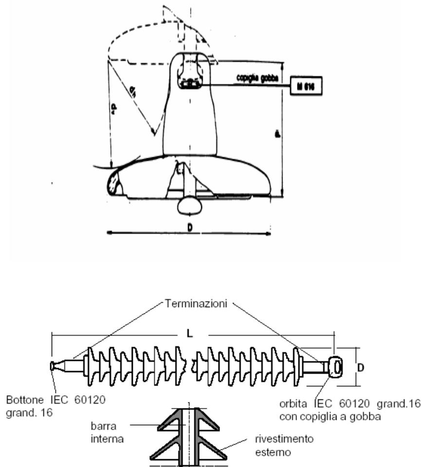
Figura G-3: Esempio di isolatori del tipo "cappa e perno" e di isolatori compositi unificati Enel
